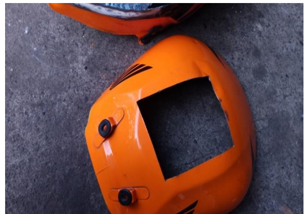
Gambar 8. Bagian Atas Tangki yang sudah Dipotong
