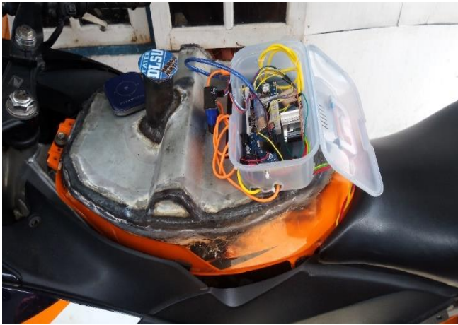
Gambar 15. Rangkaian yang Sudah Dimuat di dalam Box
