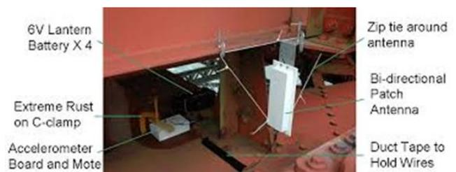
Gambar 2. Pemasangan Alat Sensor
