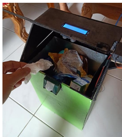
Gambar 11. Pengujian Sensor Loadcell dan HCSR04
