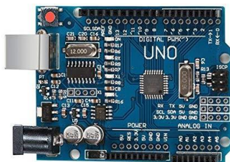
Gambar 2. Modul Arduino Uno R3 ATmega328
