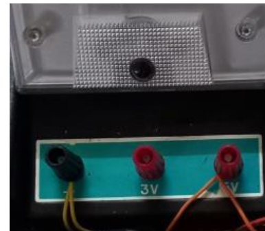
Gambar. 7. Sambungan ke Voltmeter Analog
