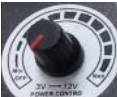
Gambar. 5. Range Tegangan Keluaran dari DC Adaptor
